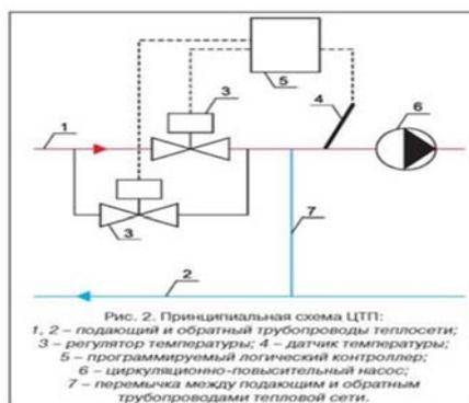
**Рисунок 1.39** – Принципиальная схема ЦТП
