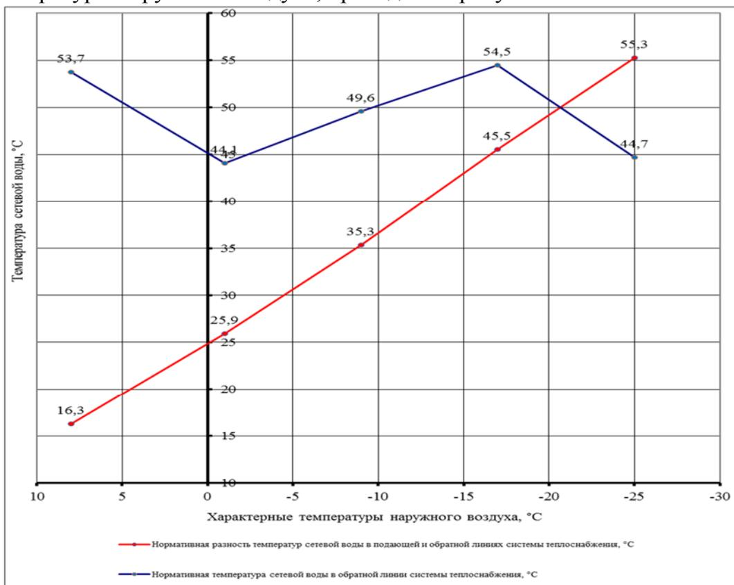
**Рисунок 1.41** – График изменения нормируемых разностей температур сетевой воды в подающих и обратных трубопроводах тепловых сетей горячего водоснабжения и температур сетевой воды в обратных трубопроводах системы теплоснабжения от СТЭЦ-2 при характерных температурах наружного воздуха
