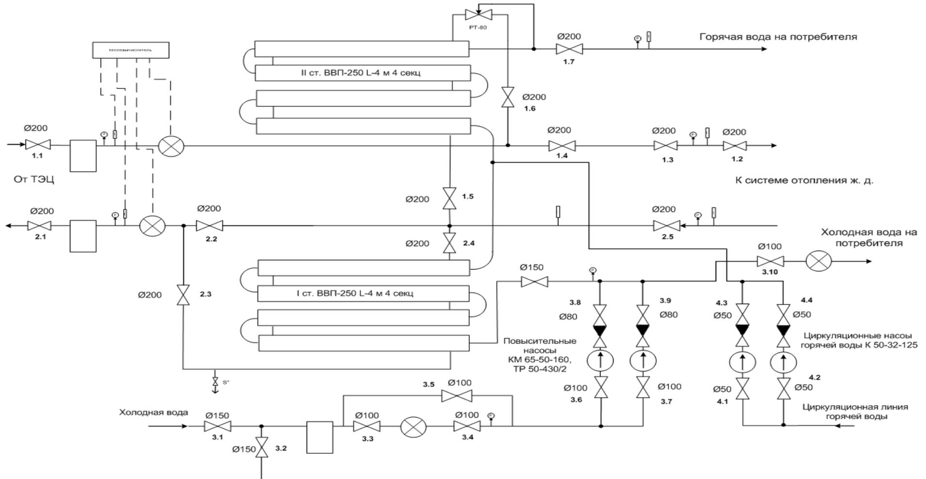
**Рисунок 1.36** – Двухступенчатая смешанная схема присоединения подогревателей ГВС с зависимым присоединением систем отопления при отсутствии регуляторов расхода теплоты на отопление в ЦТП (Типовая схема №2)
