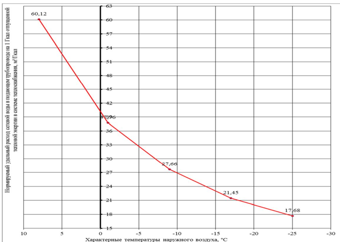
**Рисунок 1.40** – График изменения нормируемого удельного расхода сетевой воды в подающем трубопроводе системы теплоснабжения от СТЭЦ-2 тепловых сетей горячего водоснабжения, при характерных температурах наружного воздуха
