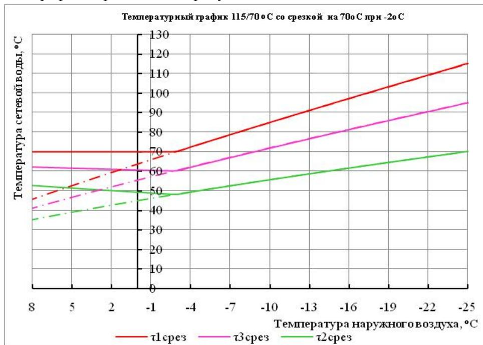
**Рисунок 1.22** – Температурный график 115/70°С со срезкой на 70°С при -2°С котельной №73 МУП "Смоленсктеплосеть"
