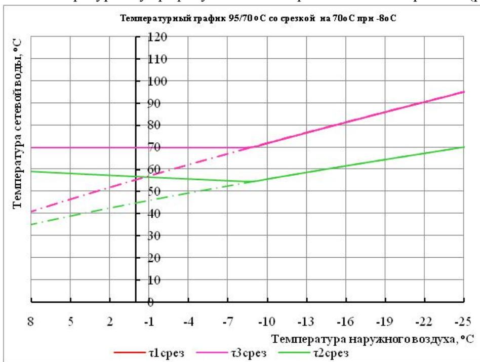
**Рисунок 1.21** – Температурный график 95/70°С со срезкой на 70°С при -5°С котельных МУП "Смоленсктеплосеть" №№ 4, 14, 15, 27, 30, 31, 34, 39,42, 43, 46, 50, 52, 56, 68, 72, 74
