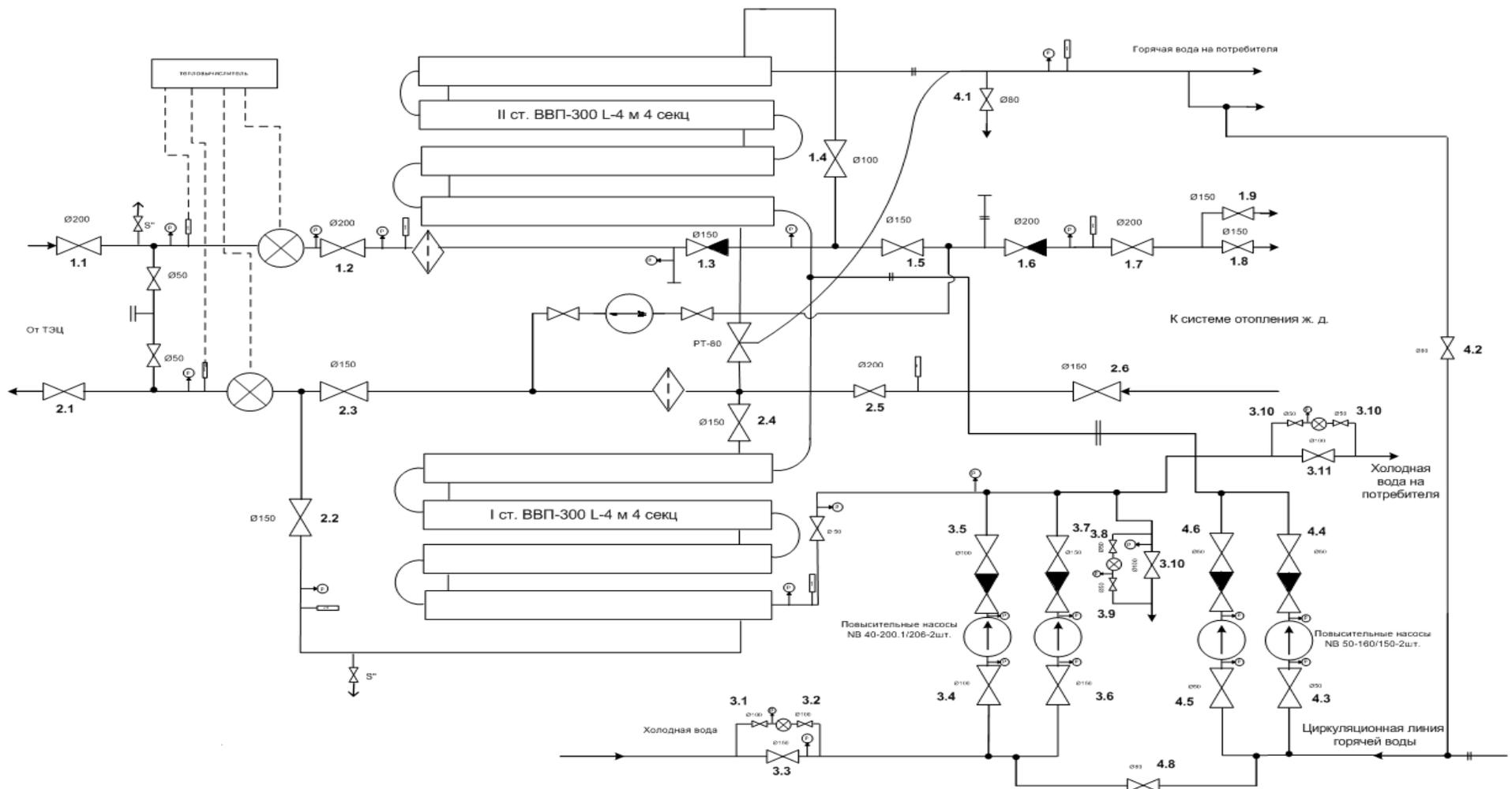
**Рисунок 1.35** – Двухступенчатая смешанная схема присоединения подогревателей ГВС с зависимым присоединением систем отопления с насосом на перемычке (Типовая схема №1)
