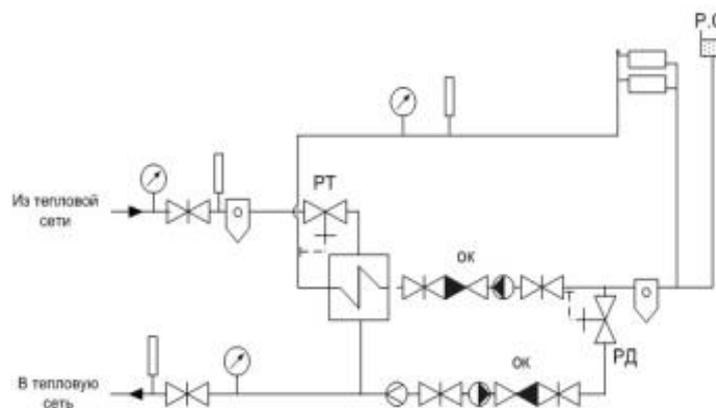
**Рисунок 1.34** – Независимая схема присоединения потребителей через ИТП
