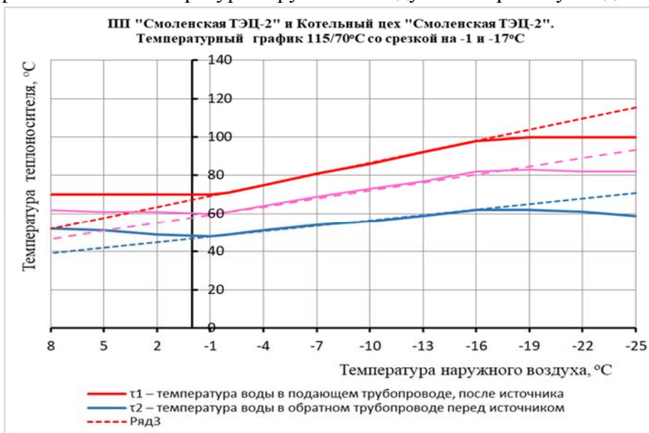
**Рисунок 1.19** – Температурный график 115/70°C со срезкой на 100°C при -17°C и 70°C при -1°C ПП "Смоленская ТЭЦ-2 и котельной котельный цех ПП «Смоленская ТЭЦ-2»
