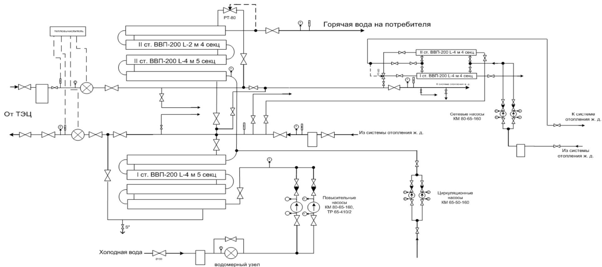
**Рисунок 1.37** – Двухступенчатая смешанная схема подключением подогревателей ГВС и независимым присоединением систем отопления (Типовая схема №3)
