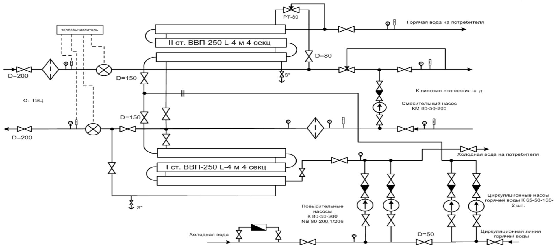
**Рисунок 1.38** – Двухступенчатая смешанная схема присоединения подогревателей ГВС с зависимым присоединением систем отопления при наличии регуляторов расхода теплоты на отопление в ЦТП (Типовая схема №4)
