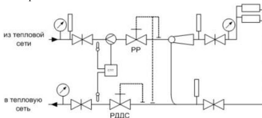
**Рисунок 1.33** – Зависимая схема с элеватором
