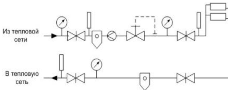
Рисунок 1.32 – Зависимая схема присоединения потребителей
