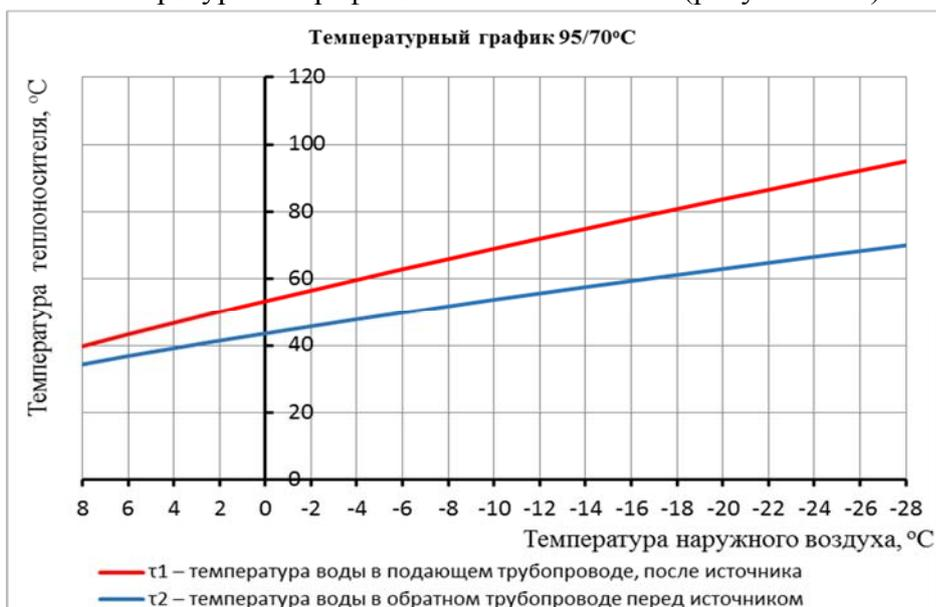
**Рисунок 1.20** – Температурный график 95/70°C котельных МУП "Смоленсктеплосеть" №№ 1, 2, 6, 7, 8, 12, 13, 16, 18, 19, 20, 23, 24, 25, 28, 29, 32, 33, 35, 36, 37, 38, 40, 41, 44, 51, 53, 54, 55, 66, 67, 69, котельной Хладосервис, котельной ул. Кутузова
