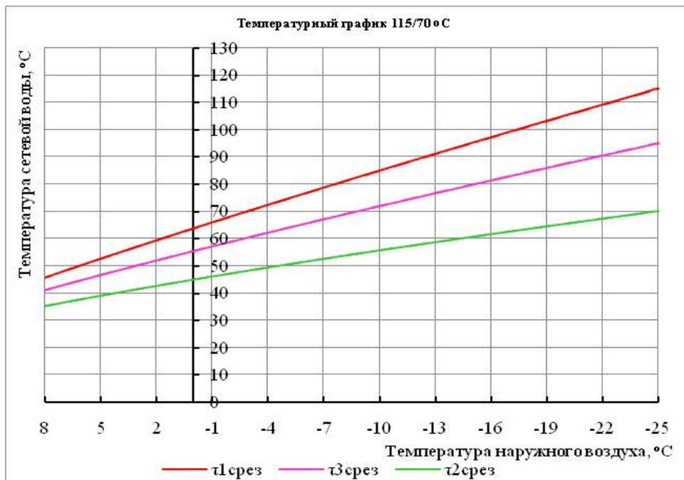
**Рисунок 1.23** – Температурный график 115/70°С котельной №21 МУП "Смоленсктеплосеть"
