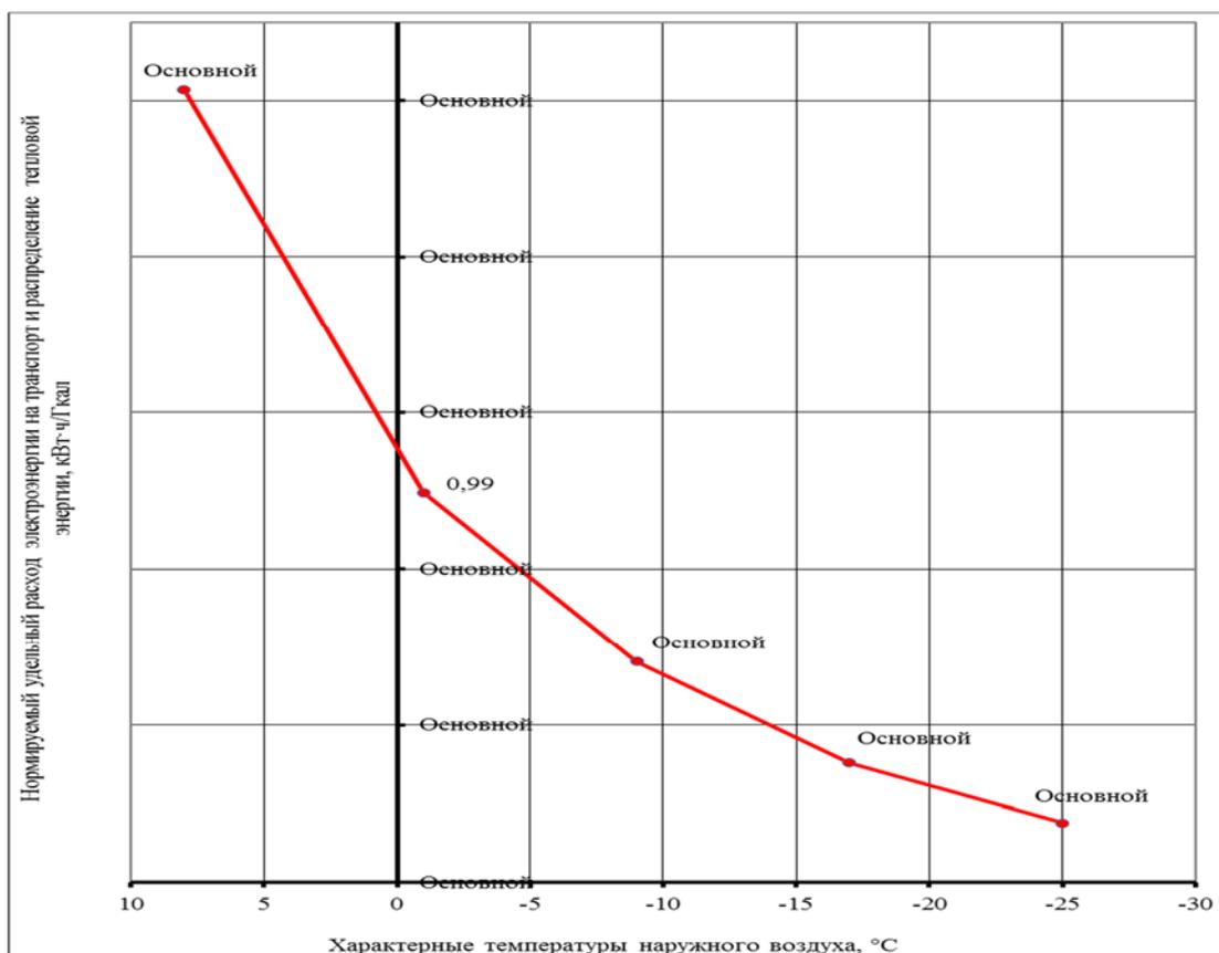
**Рисунок 1.42** – График изменения нормируемого удельного расхода электрической энергии на транспорт и распределение тепловой энергии в системе теплоснабжения от СТЭЦ-2 при характерных температурах наружного воздуха
