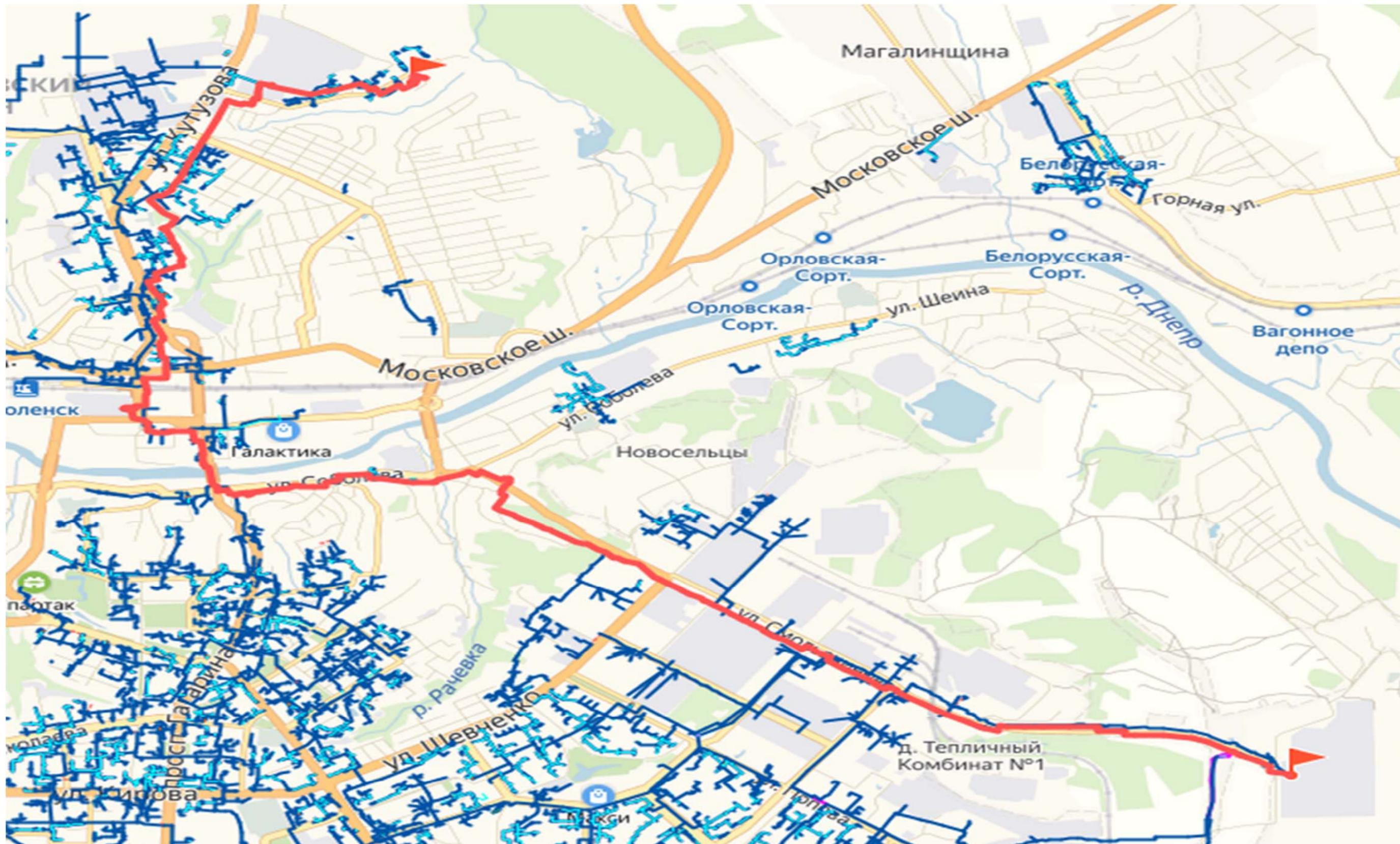
Рисунок 1.25 – Путь пьезометрического графика для участка тепловых сетей от ПП «Смоленской ТЭЦ-2»
