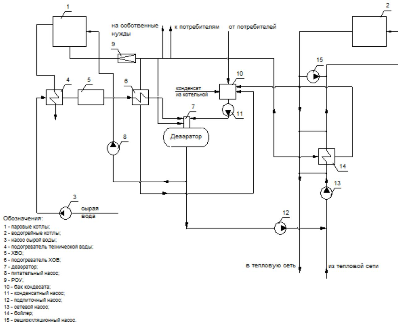
**Рисунок 1.12** – Технологическая схема котельного цеха ПП «Смоленская ТЭЦ-2»
