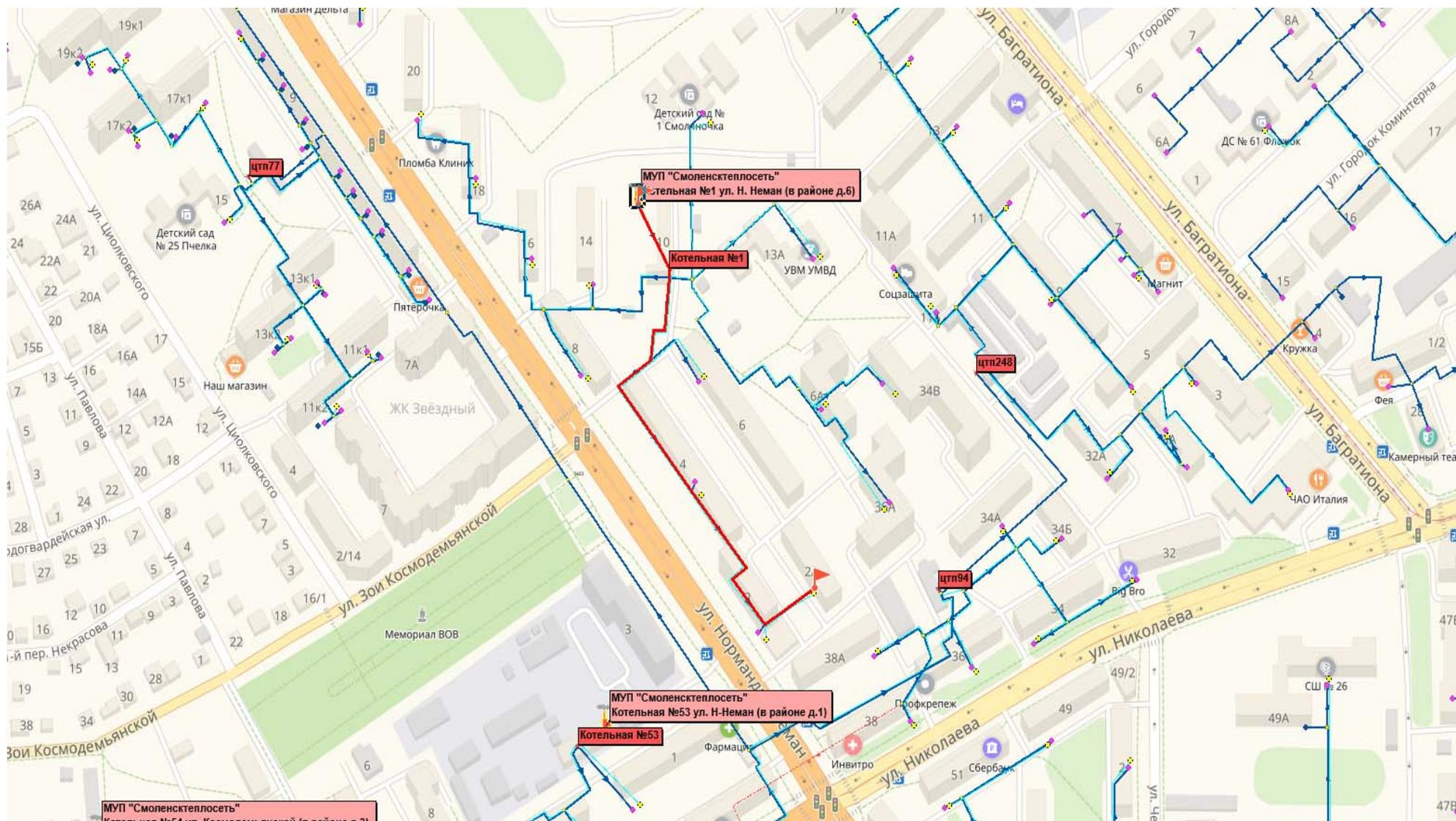
**Рисунок 1.29** – Путь пьезометрического графика для участка тепловых сетей от котельной №1 ул. Н. Неман МУП «Смоленсктеплосеть»
