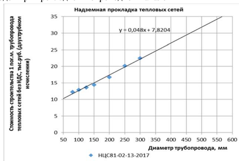
Рисунок 12.3 – Зависимость стоимости строительства трубопроводов тепловых сетей от диаметра трубопроводов при надземной прокладке на низких опорах
