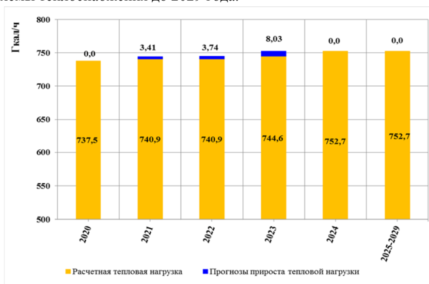
Рисунок 2.2 – Расчетная тепловая нагрузка и прирост тепловой нагрузки на расчетный период
