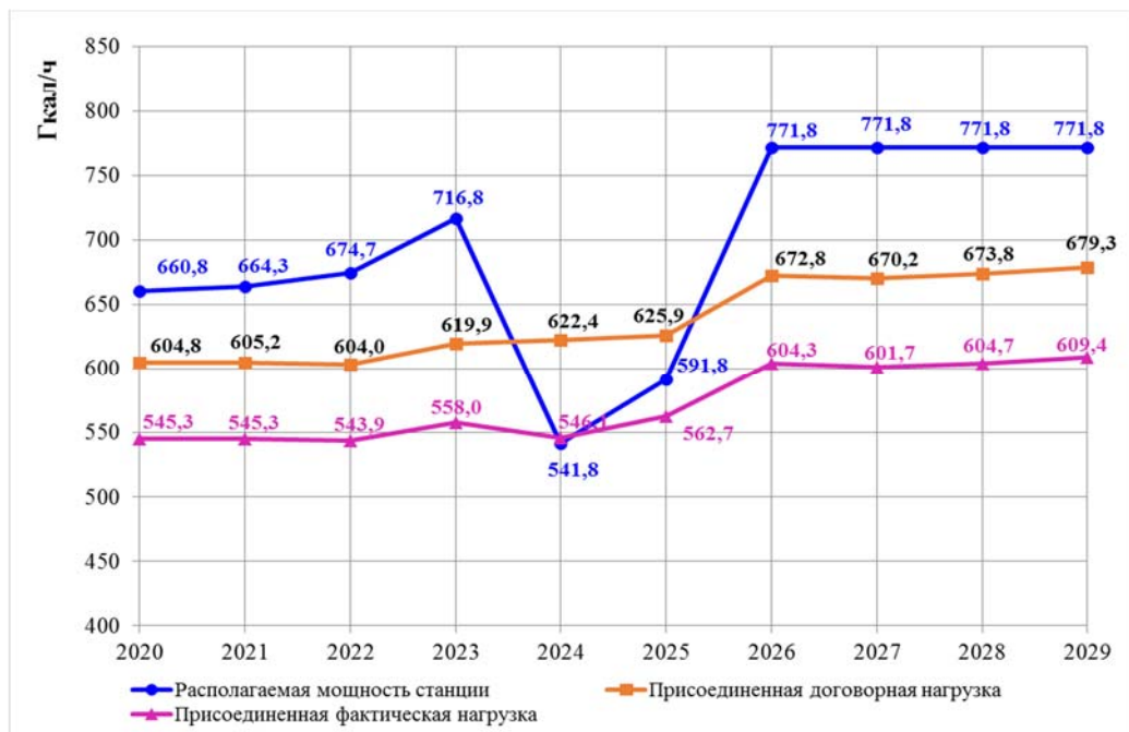
Рисунок 7.1 – График обеспеченности покрытия присоединенных тепловых нагрузок
