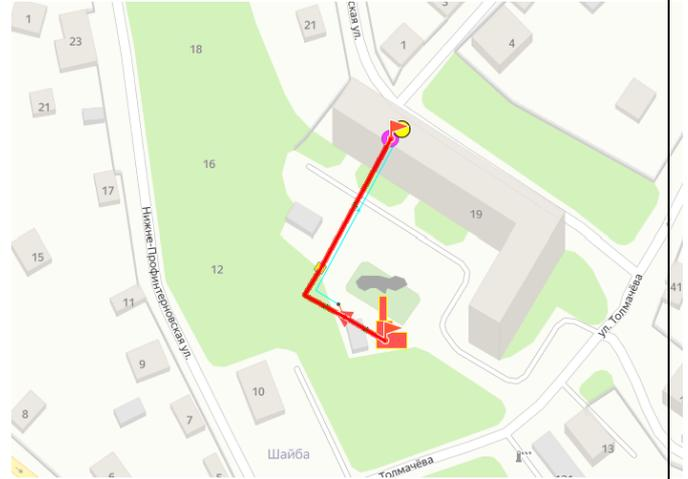
**Рисунок 11.60. Путь движения теплоносителя Котельная ул. Нижне-Лермонтовская, д.19а - Нижне-Лермонтовская улица, 19**
