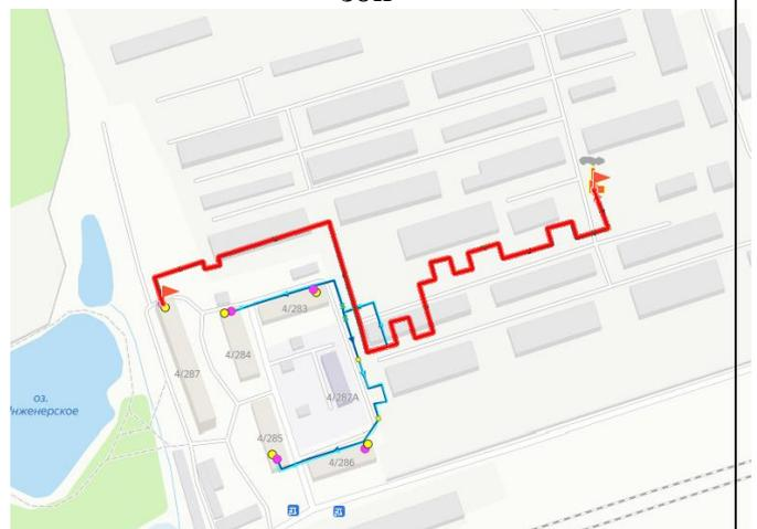
**Рисунок 11.67. Путь движения теплоносителя Котельная №83 - пос Красный бор д.4 -287**
